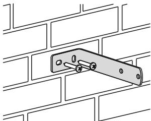
Закрепите антенну на кронштейне при помощи двух винтов. Зафиксируйте антенный кабель через отверстие «A» хомутом из комплекта.
